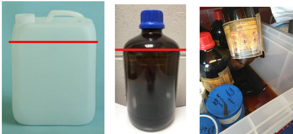
Ffigur 2. Y terfyn uchaf o ran llenwi cynhwysydd gwastraff a chanlyniadau gorlenwi a defnyddio Winchesters gwydr yn anghywir.
